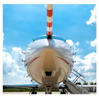
Die Nase "Noseboom" des Messflugzeugs HALO enthält Drucksensoren. The noseboom of the HALO research plane contains pressure sensors.
